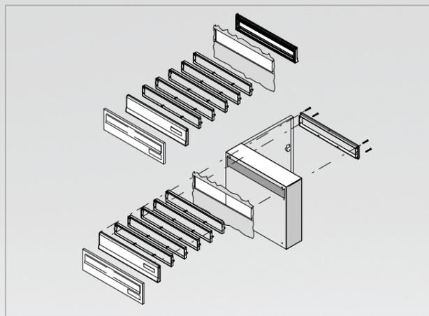
Montage der Einzelklappe Seite 65 und 67 mit einem Durchwurfhals-Set: Damit existiert ein flexibles System für gängige Materialdicken. Mit dem Abschlussrahmen wird der Briefkasten befestigt.
